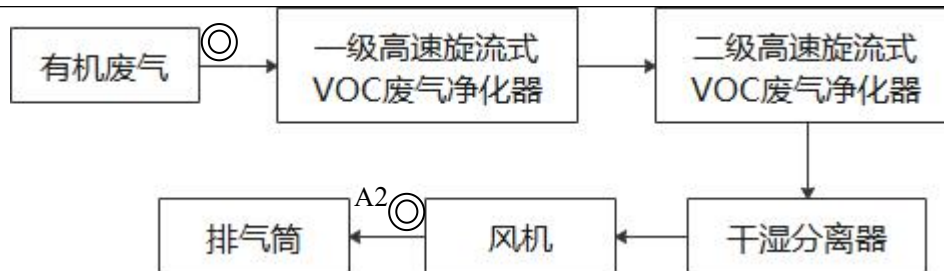
图 3-4 有机废气处理工艺工艺流程图
