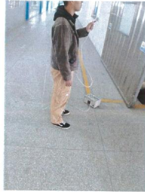
车间五车间门口无组织废气采样
