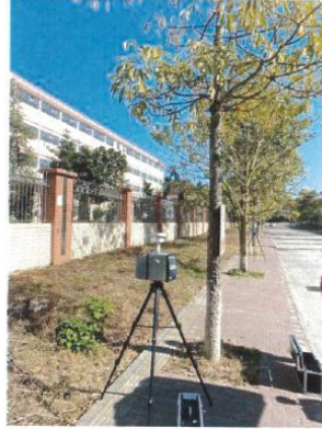
厂界无组织废气采样
