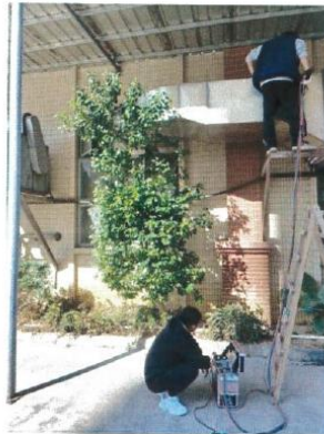
厨房油烟废气处理前采样口
