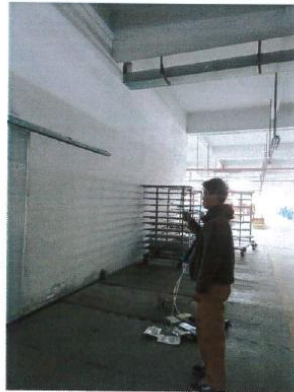
车间一车间门口无组织废气采样
