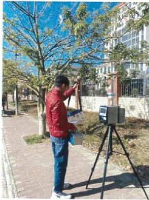
厂界无组织废气采样
