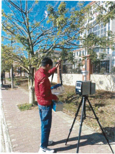
厂界无组织废气采样
