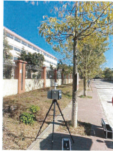
厂界无组织废气采样
