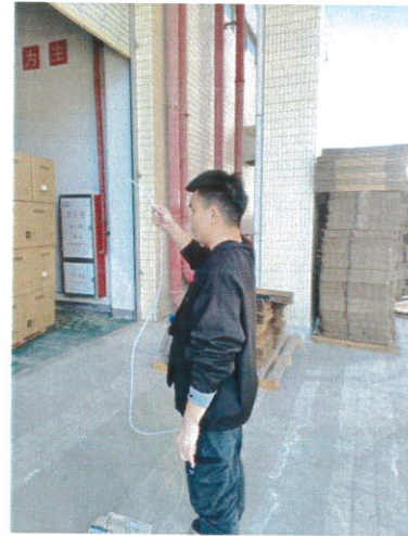
车间八车间门口无组织废气采样
